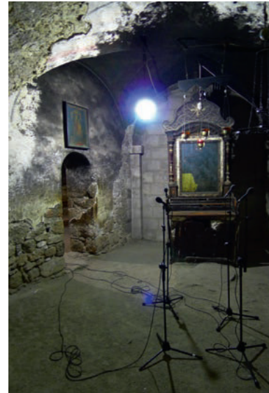
Vier Mikrofone: Voraussetzung, um die Akustik der Grabeskirche zu vermessen. (Foto: Joachim Hoas)
